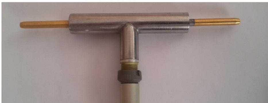
Рис. 1. Жидкостной (проточный) датчик
